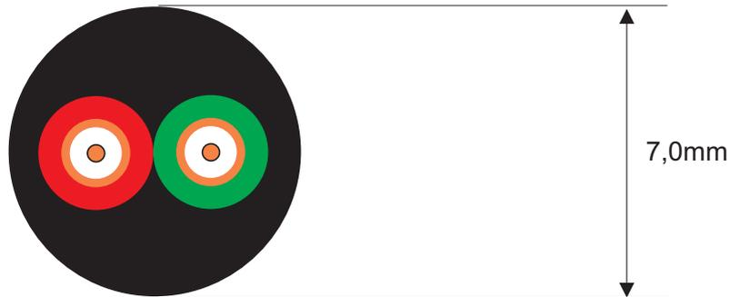
**Aufbau:** 2 x 75Ohm Koaxialkabel 0,4/1,7
