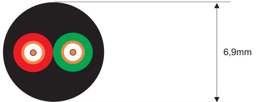
**Aufbau:** 2 x 75Ohm Koaxialkabel 0,36/1,7
